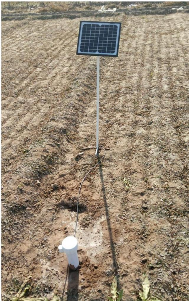
向上拔出设备顶盖后，按下开关键，设备即可正常工作。建议在泥浆恢复正常状态后再进行正常工作。
