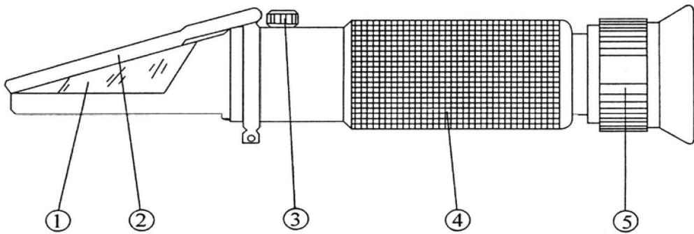
1. 棱镜      2. 盖板      3. 校正钉      4. 保护套      5. 目视系统
