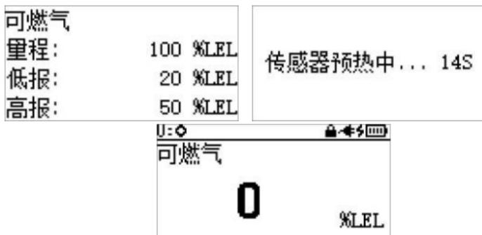
进入正常检测模式，待显示数据稳定后（不同种类气体稳定时间不同，一般为 5-30 分钟），主窗口显示的数据即为当前气体浓度值。上电稳定一个小时内，达到最佳检测状态。
