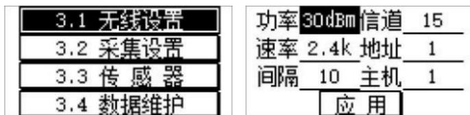
在无线参数设置页面可设置无线模块的发射功率、信道、空中速率和探测器的上传地址、主机地址与上传间隔（单位：秒），若需修改，可通过遥控器移动光标到对应参数上按确认键进入修改模式，修改完成后按确认键退出修改模式，移动光标到应用按钮并确认以应用修改后的设置。
