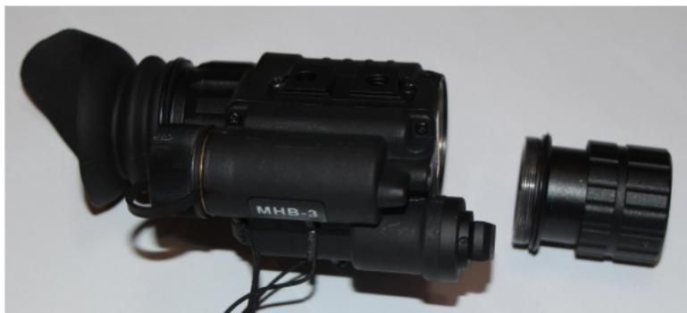
3. 将四倍物镜旋转安装上（旋转开关可手持远距离观察）
